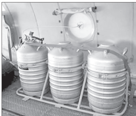
Так выглядит генератор частиц льда, которые «сбрасывают» на облака.
