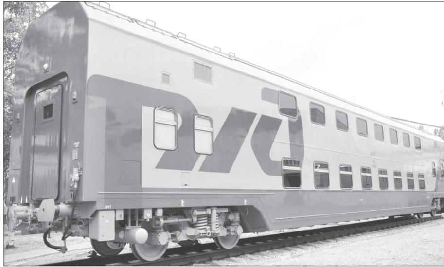
движения на скоростях до 160 км/ч, а кузова с гладкой обшивкой боковых стен будут изготавливаться из коррозионно-стойких (нержавеющих) сталей. Благодаря этому срок службы вагонов составит 40 лет.
